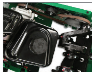
Klikový mechanismus hrotů Hroty pracují do hloubky 7 cm i v tvrdších půdních podmínkách a nedeformují vytvořené otvory.
